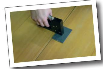
Appareil puissant en acier pour la fixation de revêtements plastiques, matériaux d'isolation, moquettes, sur tous types de bois..
