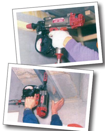
Pour une fixation pneumatique à haute pression jusqu'à 23 bars.
