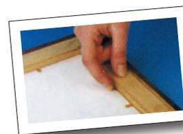
Enfoncement horizontal de lamelles flexibles.
