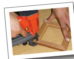
Fixation des baguettes de cadres avec une coupe de 90°.
