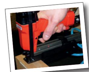
Appareil pour une grande précision d'agrafage pour l'emballage de cartons ondulés et pour la fermeture de couvercles.
