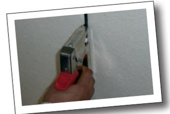
Agrafeuse spécialement conçue pour la pose de câbles de diamètre allant jusqu'à 6 mm.
