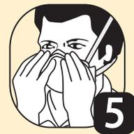
Contrôler l'étanchéité en expirant fortement et vérifier qu'aucune fuite d'air ne se produise sur le pourtour du masque. Réajuster si nécessaire et re-contrôler
