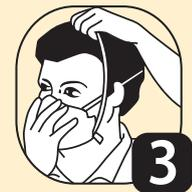
Prendre la bande élastique supérieure et la passer derrière la tête, prendre la bande élastique inférieure et la passer derrière la nuque (pour la gamme CONFORT PLUS ajuster les brides réglables).
