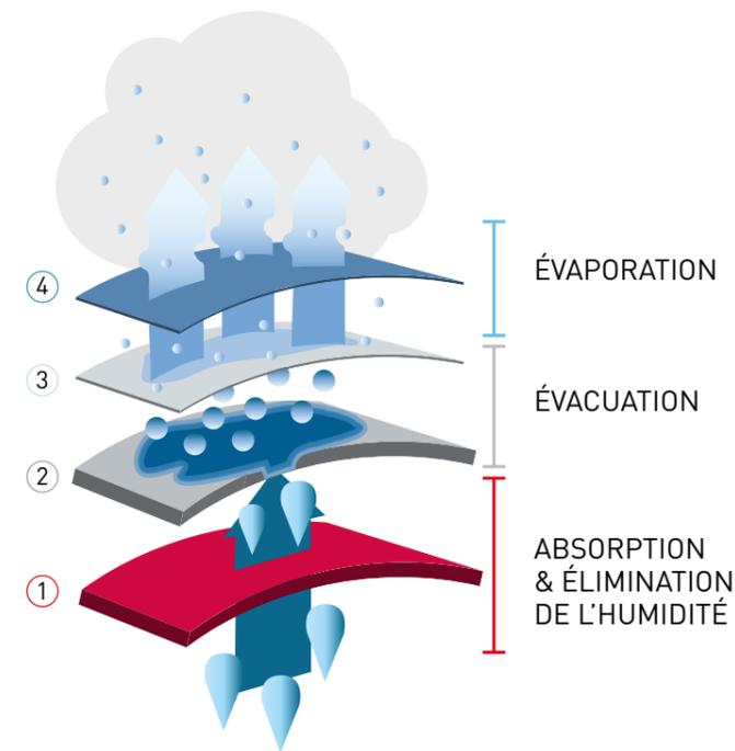
**Membrane technique** étanche en laminé PES Polyester (100% imperméable) et respirante à la fois (évite la condensation)
