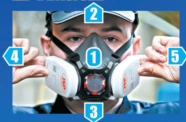
**INSPIREZ** - L'air ne doit pas pouvoir passer à travers le masque. **1 Regardez en avant** Ajustez et répétez l'opération afin d'obtenir une étanchéité parfaite. Répétez ce processus tout en regardant **2 en haut**, **3 vers le bas**, **4 à gauche** et **5 à droite** pour compléter la vérification.
